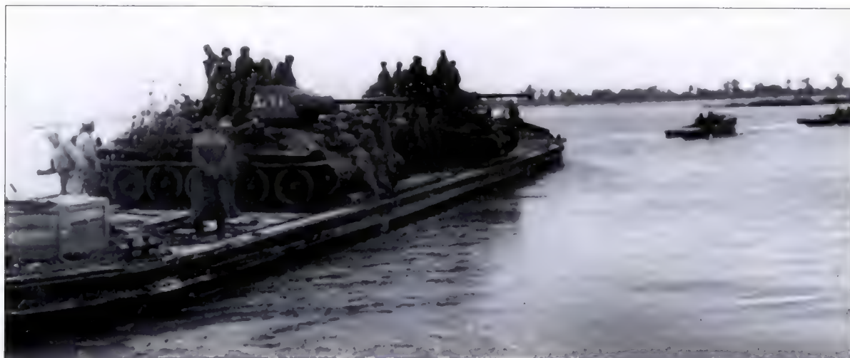
Una barcaza fluvial transporta dos carros soviéticos T-34 modelo 1943 sobre el Vístula. La barcaza es arrastrada por dos motoras BMK-70. (Sovfoto)
