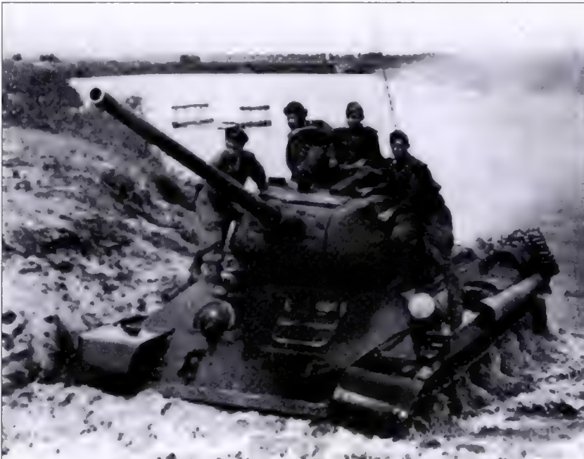
Un T-34-85 cruza el río Bug durante la operación «Lvov-Sandomierz». Aunque hubo algunos intentos improvisados de usar manguerotes de vadeo profundo en las operaciones de cruce de ríos, los carros necesitaron normalmente vados poco profundos o equipo de ingenieros para cruzar los grandes ríos. (Sovfoto)
