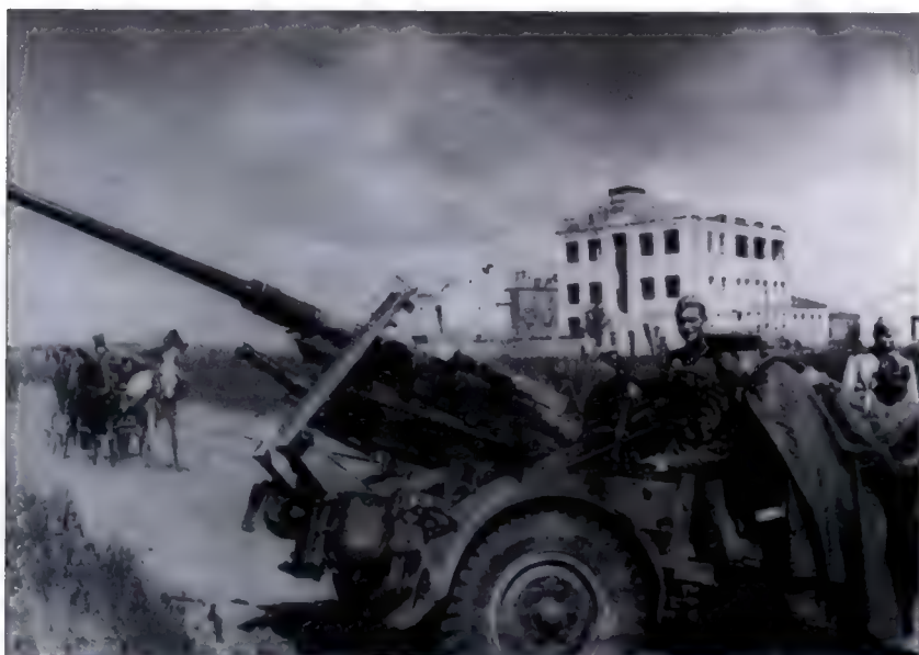
Soldados del Ejército Rojo observan el botín de guerra después de la captura de Vitebsk. La pieza es un cañón antiaéreo Flak 36 de 37 mm sobre un cureña Sonderanhanger 52. (Sovfoto)
